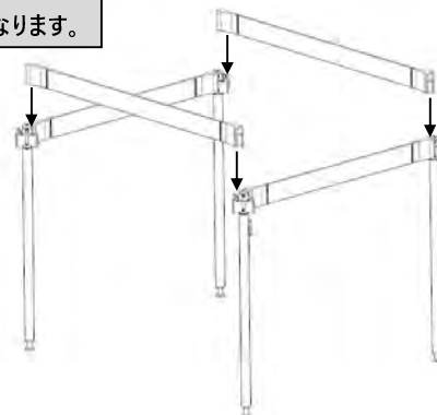
門型のフレームに長手方向のビームを組み立てる
